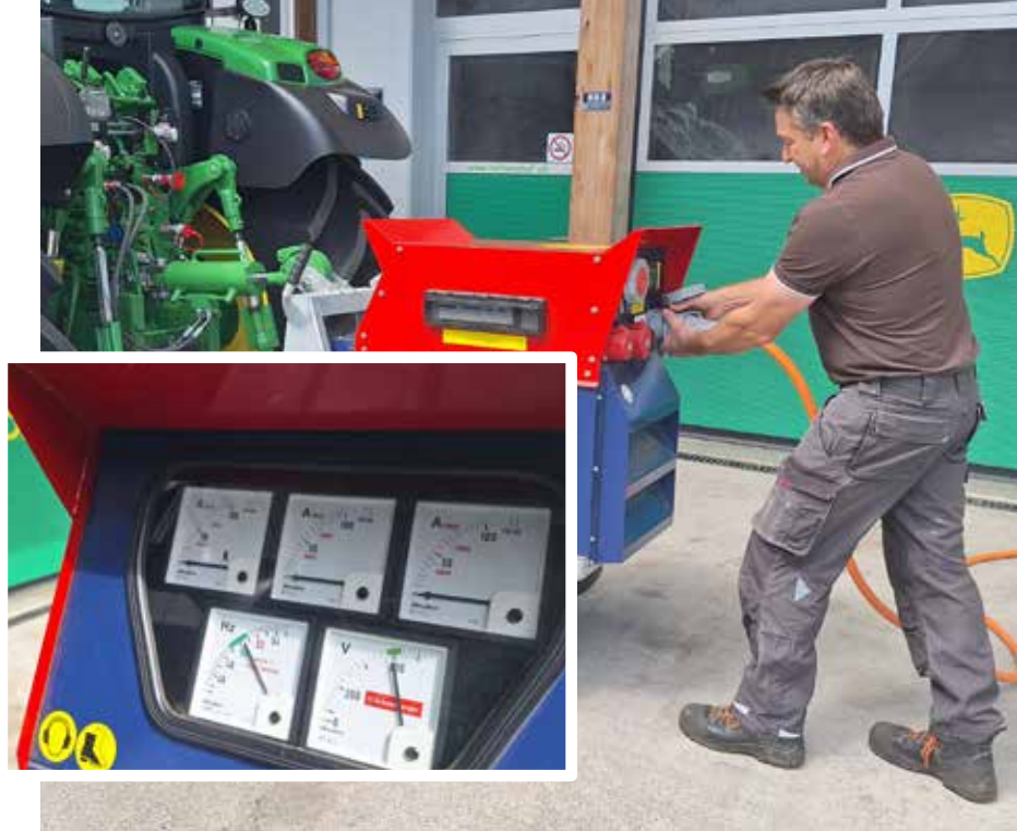
Urban Schwager hat für seinen Betrieb den Zapfwellengenerator als zuverlässigste Lösung für einen Stromausfall gewählt, um seine Tiere ausreichend versorgen zu können.
