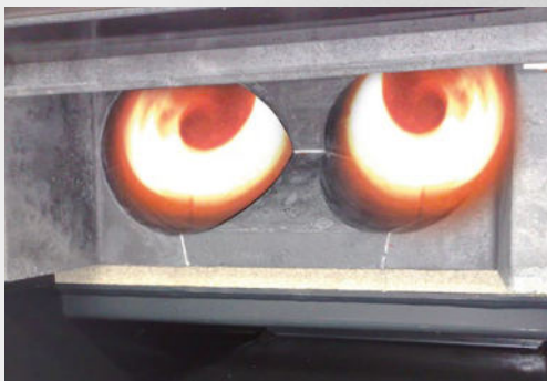
Höchste Effizienz durch einzigartige Doppelwirbel- brennkammer
