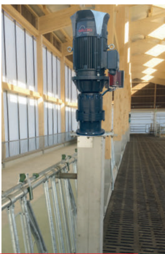
Erhöhte Montage auf Konsole im Laufstall
