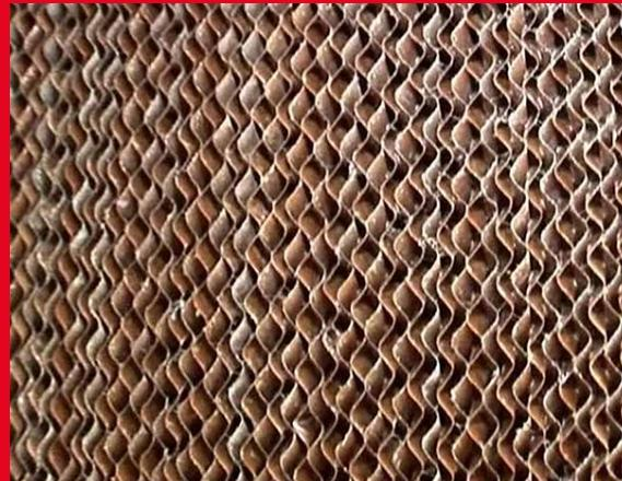
Das Kühlwasser wird mit einer Pumpe über die ganze Länge des Zellulosevorhangs gepumpt und verteilt.
