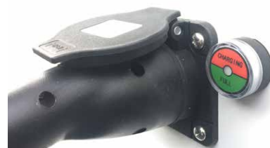
Steckdose mit Ladeanzeige des integrierten Ladegerätes
