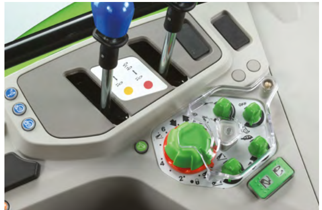
Bedienelemente der elektronischen Hubwerksregelung.
