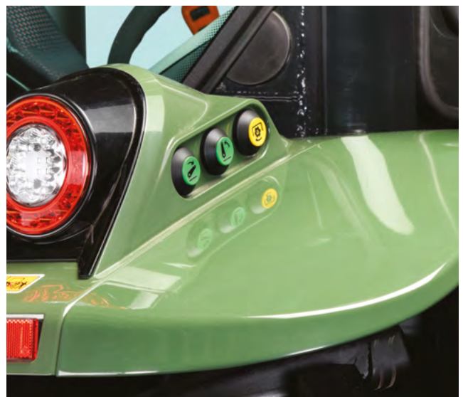
Externe Bedienung für Zapfwelle und Heckkraftheber.
