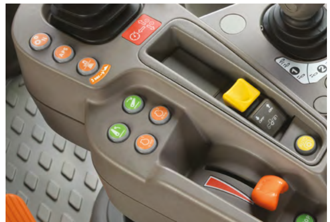
Elektronische Handgas mit zwei speicherbaren Motordrehzahlen.
