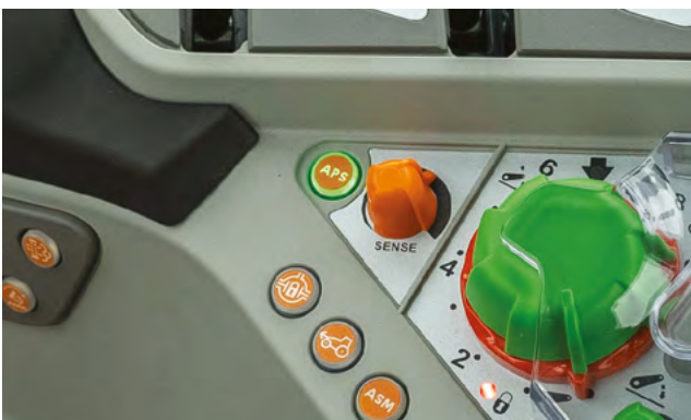
APS-Aktivierung mit einstellbarem Ansprechverhalten.
